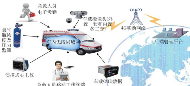
图 2 救护车信息采集与管理子系统结构
