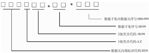
图 1 数据集标识符与数据元内部标识符的关系和结构
