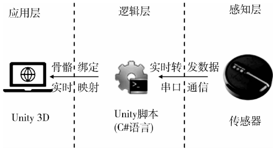
图3 驱动程序原理
