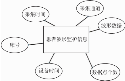
图 4 患者波形监护信息实体 E - R 图
